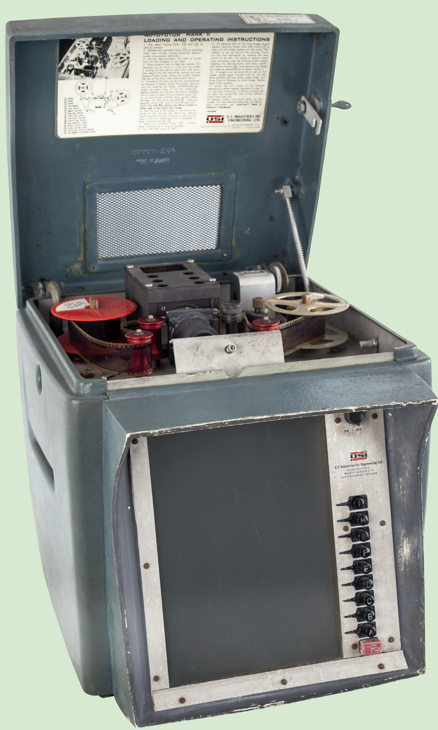
Autotutor Mark 2, machine conçue vers 1965 par Norman Crowder, produite par US Industries Inc. Engineering Ltd. Inv. MNE n°1983.01332.001
