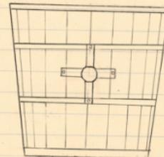
Comme on peut s'en rendre compte par le dessin ci-dessus le douillat est muni de chaque côté à 0,50 de son fond, c'est à dire à la moitié de sa hauteur, d'un crochet par lequel il est facilement soulevé. Sauf il est plus de largeur, comme il est plus large du haut que du
