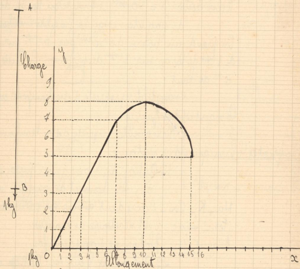
Jusqu'à 4 kg l'allongement était proportionnel à la charge, au dessus de 4 kg il n'est plus proportionnel à la charge. 4 kg est la limite d'élasticité à partir de 4 kg le fil ne reprend plus sa longueur primitive. Le fil se rompt pour une charge de 8 kg. 8 kg est la charge de rupture.
