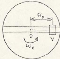
On considère une table de moment d'Inertie  $I_0$ , tournant autour d'un axe vertical passant par son centre  $O$ . Sur cette table un petit véhicule  $v$  de masse  $m$  se déplace sans frottement sur deux rails parallèles situés de part et d'autre du centre  $O$  et à égale distance de ce point. A l'extrémité du véhicule, la plus proche de  $O$ , est attachée une corde de masse négligeable passant, par l'intermédiaire d'une poulie, dans l'axe vertical de la table.
