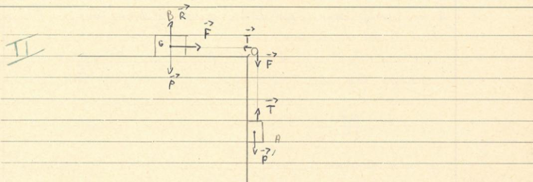
1°) Le solide B est soumis à son poids  $\vec{P}$ , à la réaction R du support et à une force  $\vec{F}$
