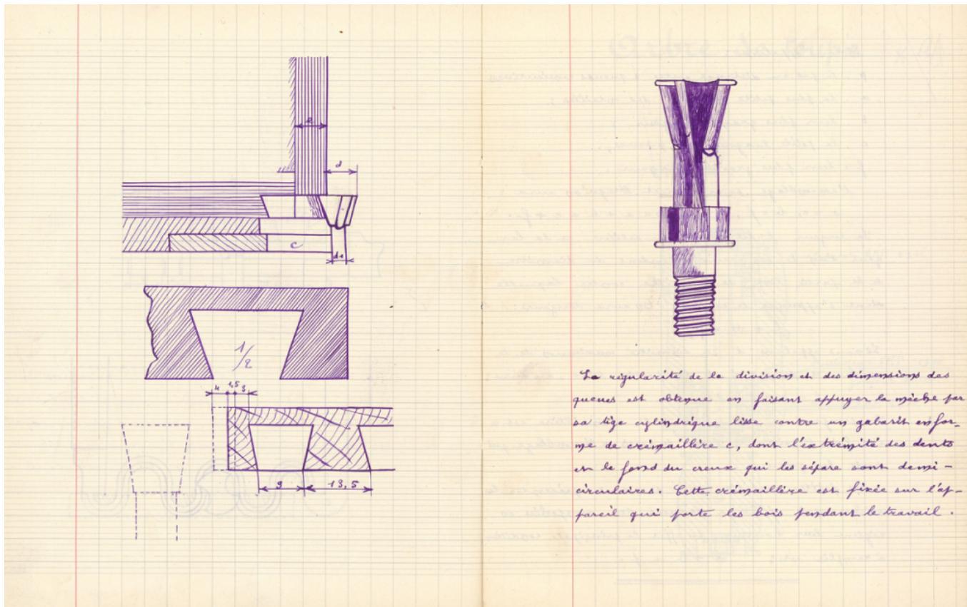
La régularité de la division et des dimensions des queues est obtenue en faisant appuyer la mèche par sa tige cylindrique lisse contre un gabarit en forme de croisaille  $c$ , dont l'extrémité des dents en le fond du creux qui les sépare sont demi-circulaires. Cette croisaille est fixée sur l'appareil qui porte les bois pendant le travail.
