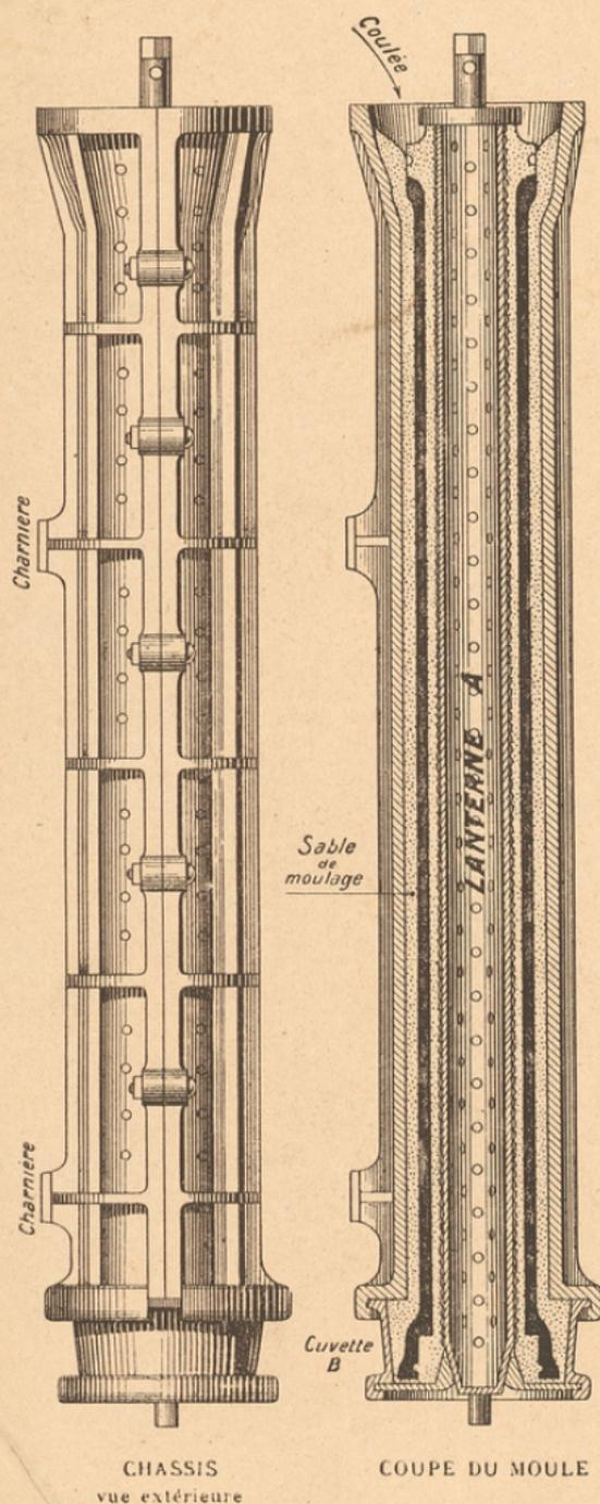
La fabrication des tuyaux en fonte coulés verticalement comprend les opérations suivantes :
