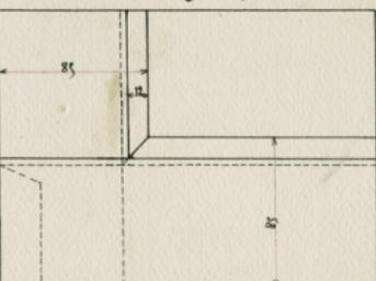
Tenon et mortaise à angle vif aux deux parements
