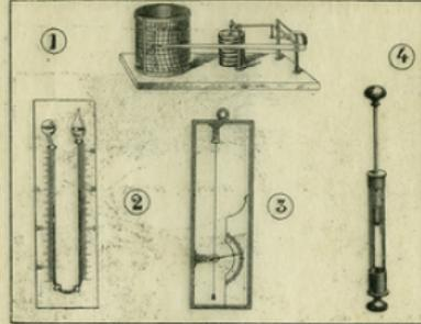
Fig. 2. — 1. Baromètre. — 2. Thermomètre. — 3. Hygromètre. — 4. Briquet à air.
