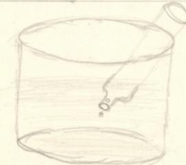
3) En inclinant la bouteille on fait passer l'air qu'il elle contient dans le flacon B.
