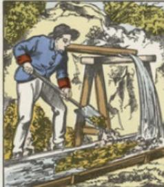
On lave le minerai concassé dans un fort courant d'eau qui entraîne la plus grande partie des matières étrangères. Le fer, par lui-même, est infusible. Il faut le transformer en **fonte**, c'est-à-dire y ajouter du **carbone**, pour qu'il puisse fondre.
