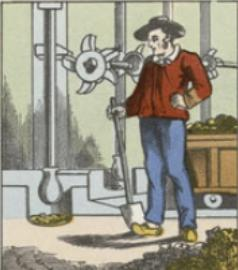
On commence par concasser le minerai sous de puissants pilons appelés **bocards** ; le cassage du minerai en menus morceaux a pour objet de faciliter sa fusion et, par conséquent, d'économiser le combustible.
