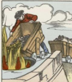
On transforme le minerai ou oxyde de fer en **fonte** fusible dans un haut fourneau, alimenté jour et nuit et où on verse successivement sans interruption un wagon de coke, un wagon de minerai et un wagon de **fondant** ou **castaine**.
