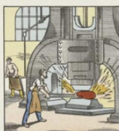
Les **marteaux-pilons**, puissants outils dont les plus lourds pèsent jusqu'à cent tonnes, sont mis par la vapeur et fonctionnent avec une régularité de mouvement telle qu'ils peuvent écraser une noisette dans la coque d'une noisette sans atteindre pour l'amande. Leur action expulse des loupes.
