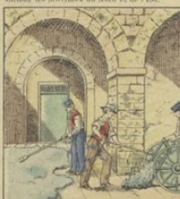
**La germination** de l'orge mouillée se fait ensuite dans le **germoir**, avec dallage à une température de 15 à 22°. Pendant la germination, il se développe dans le grain un principe chimique, la **diamidase**, qui transforme l'amidon en matière fermentable. La germination est terminée quand l'amyloïde de la graine a développé une radicule atteignant les 2/3 de la longueur du grain.
