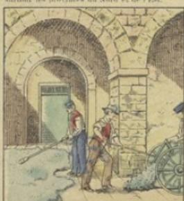
**La germination** de l'orge mouillée se fait ensuite dans le **germoir**, avec dallage à une température de 15 à 22°. Pendant la germination, il se développe dans le grain un principe chimique, la **diamidase**, qui transforme l'amidon en matière fermentable. La germination est terminée quand l'anthéryose de la graine a développé une radicule atteignant les 2/3 de la longueur du grain.
