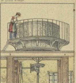
**Le brassage.** — On dessèche à l'air chaud pendant trois jours au moyen de **tourrailles**, appareils comprenant un four et une surface de dessiccation constituée par une toile métallique. Le malt torréfié possède une sorte de torréfaction et renferme moins d'amidon et plus de sucre que le grain d'orge.
