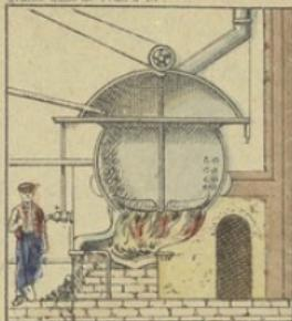
**II. Brassage.** — Il faut alors préparer le mout au débordement aquueux de maïs et de houblon. On pratique pour cela la **trempe** et la **cuisson**. La trempe qui a pour but de dissoudre dans l'eau les principes solubles et d'achever la modification de l'amidon en dectrine se fait soit par débordement soit par infusion.
