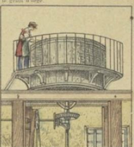
**Le trempe par infusion** se fait dans un récipient nommé **cave-matière**. L'eau à 40° est versée sur le mout puis on fait arriver de l'eau à 65° ; le brassage est suivi d'un repos d'une heure. Le mout est décanté puis on répète suivant une infusion à 75° et une à 80°. Le résidu insoluble est appelé **décroche**.
