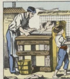
Les briques sont les premiers matériaux artificiels que l'homme ait fabriqués. Primitivement, on emploia des pierres plates et plates, mais ce n'est pas beaucoup plus tard que la cuve au four fut appliquée. La pâte qui servait à fabriquer les briques ou les tuiles est obtenue en mélangeant et pétrissant ensemble de l'argile commune et du sable.
