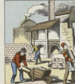
La pâte est placée dans des moules au sortir desquels la brique crue, ainsi obtenu, est mise à sécher au soleil, puis à cuire dans des fours ou éteinte jusqu'à 30 à 35 jours. Une brique de bonne qualité doit avoir une couleur rouge brûlé foncé et rendre un son clair quand on la frappe.
