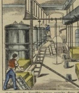
Cette viande liquéfiée passe ensuite dans des appareils à clarifier qui éliminent la graisse, l'albumine et les autres parties qui empêcheraient la conservation de l'EXTRAIT. Il en sort un sirop clair, véritable jus de viande que des pompes à air rotatif dans des réservoirs à évaporer d'une consistance d'environ 5000 litres.
