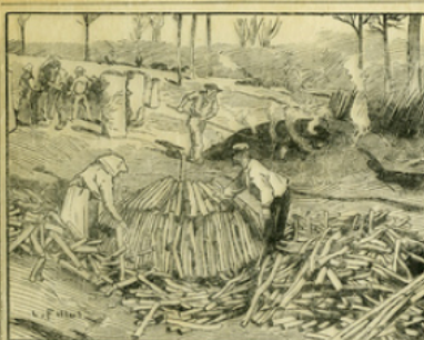
Fig. 7. — Les phases de la fabrication du charbon de bois: construction d'un four; un four en combustion; mise en sacs.
