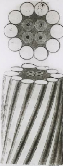
Fig. 106. — Câble de Douvres à Calais et section du même câble (grandeur naturelle).
