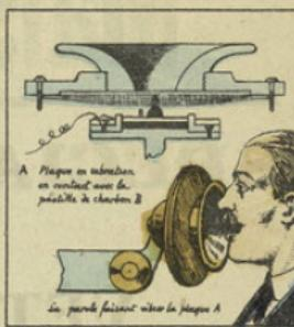
Tout son produit devant la membrane la fait vibrer et celle-ci, en faisant varier par ses oscillations le champ magnétique de l'aimant, développe dans cet aimant des courants induits transmis par la ligne à l'autre appareil.
