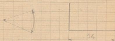
Les chiffres de côtés doivent être justifiés avec soin de façon à faciliter leur lecture pour l'ouvrier qui fabrique la pièce.
