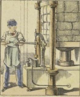
La PRESSE HYDRAULIQUE dont l'action est si puissante, est due à notre grand Pascal en 1642. Son principe est l'incompressibilité de l'eau. Elle permet d'obtenir des pressions considérables ou de soulever des poids énormes comme, par exemple, le tablier en fer d'un pont métallique, pour le poser sur ses piles.
