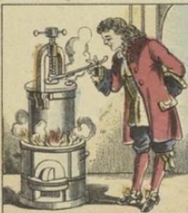
En 1681, Denis Papin inventa une **MARMITE** à cuire la viande et les os au moyen de la vapeur concentrée en vase clos. Pour pouvoir suivre la cuisson des viandes dans son **DIGESTEUR**, il y fit un trou qu'il boucha avec une soupape. Telle est l'origine de la célèbre soupape de sûreté des chaudières à vapeur.
