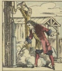
En 1672, Huygens fabrique un cylindre muni d'un piston sous lequel il faisait détoner de la poudre à canon. Le piston s'élevait brusquement : on fermait le vide au-dessous de lui, et alors, chassé par la pression de l'air, le piston redescendait dans le cylindre entraînant après lui des poids ou l'eau d'un puits.
