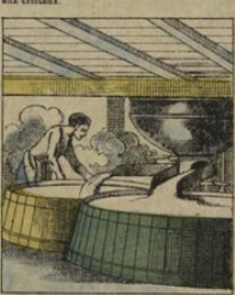
Le sirop à la sortie des filtres est envoyé aux APPAREILS À CURER où l'eau s'évapore et les cristaux de sucre se forment. La masse qui se met tombe dans de grandes cuves appelées RÉCHAUFFEURS, d'où des tuyaux la distribuent aux ateliers de moulage.
