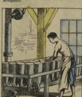
Afin de précipiter l'écoulement du sirop de clairage par le petit trou ménagé au bas de toutes les formes à pain de sucre, on les place sur un appareil nommé égoutteur, qui à l'aide du vide aspiré dans l'appareil, suce et aspire rapidement le sirop resté liquide; le sucre cristallisé peut sécher alors rapidement.
