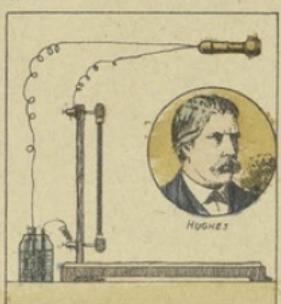
Heureusement, la découverte du **microphone** due à Hughes, vint fournir un transmetteur bien plus puissant ; de sorte qu'on appela aujourd'hui téléphone un dispositif dans lequel sont combinés le transmetteur microtéléphonique de Hughes et le récepteur magnétique de Bell ou, plus exactement, des dérivés de ces appareils.
