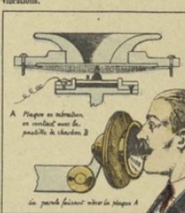
Tout son produit devant la membrane la fait vibrer et celle-ci, en faisant varier par ses oscillations le champ magnétique de l'aimant, développe dans cet aimant des courants induits transmis par la ligne à l'autre appareil.
