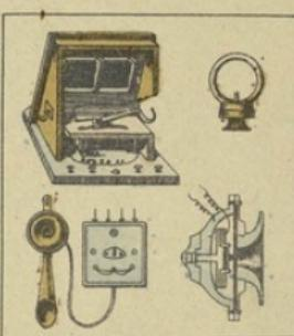
On construit, en effet, une variété infinie de récepteurs et de transmetteurs plus ou moins simplifiés. Nous citerons seulement les transmetteurs Ader, Bailloux, Bert d'Arsouval, Berthon, Dockart, Solid Back et les récepteurs Ader, Aubry et Bert d'Arsouval.
