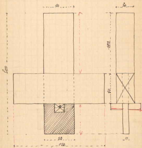
30/4-97 IV La pièce mécanique qui devient nécessaire d'autres pièces de grande taille sont dirigées en plusieurs mortaises, servies par une sorte d'épaule joint, une simple ramure dans laquelle s'inscrit une fente faite de tenon pour l'affaiblissement des pièces ainsi assemblées.
