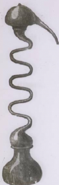
Appareil distillatoire de J.-B. Porta.
