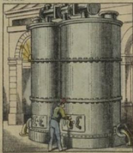
Puis le gaz est soumis à d'autres épurations, car sa pureté fait sa qualité. Un des appareils les plus importants consiste en COLONNES pleines de briques pilées chargées de produits chimiques à travers lesquels le gaz se divise et se filtre.
