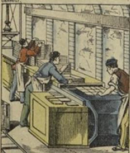
Le Chocolat moulé à l'état pâteux et chaud a besoin, pour se débouler, d'être solidifié par un refroidissement rapide dans des toilettes dans lesquelles se mouvent dans des conduites roulantes froides et d'invention brevetées de MM. LOMBART et BILLAUDOT, sont chargées de moulés remplis de chocolat, et le refroidissement s'y opère avec une rapidité extrême.
