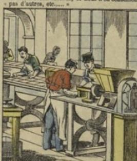
Le Chocolat, à l'état de pâte molle, est versé dans une trémie superposée à une vis d'Archimède destinée à l'extraire l'air. Puis il est pesé et mis dans des moules qui lui donnent sa dernière forme. Ces moules sont placés sur des tables à trépied appelées « claquettes », dont les ressorts tiennent la pâte également.
