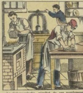
La Galvanoplastie, résultant de ces nombreuses expériences, est donc l'art de reproduire un objet ou simplement de le recouvrir d'une couche métallique.
