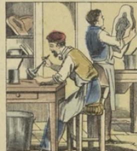
Lorsqu'on a le moulé de gutta, on le recouvre avec un pinceau d'une légère couche de plombagine destinée à le rendre conducteur du courant. La plombagine s'applique avec un grand soin sur les formes les plus délicates sans amerer l'engorgement des détails ni la déformation du modèle.
