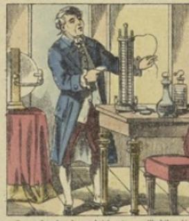
Ces recherches le conduisirent, par d'habiles déductions, à la découverte de la pile qui porte son nom. La **Pile de Volta** se compose de disques de cuivre et de disques de zinc, isolés l'un de l'autre par une couche de drap ou de carton trempé dans l'eau acide, et empilés entre deux colonnettes de verre.
