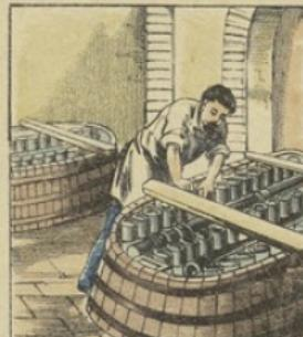
Grâce à elle, on peut cuire, doré, argentier, nickerier, etc., tout objet, vase, statuette, modèle quelconque, bois, etc., qu'on dépose dans le bain métallique, ou bien le reproduire à l'infinité. C'est par la galvanoplastie qu'on a recouvert d'une épaisse couche de bronze les fontaines et les réverbères en fonte de la ville de Paris.
