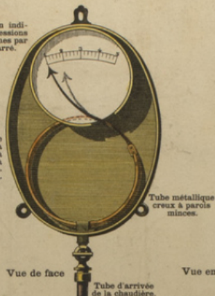
MANOMÈTRE servant à mesurer la pression de la vapeur.
