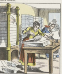
Le papier de qualité supérieure, destiné aux usages autres que les journaux, est coupé en feuilles suivant des formats usités, mis en presse, puis compté par paquets de 500 feuilles qui forment ce qu'on appelle une rame. La Rame se subdivise en 20 mains de 25 feuilles chacune.
