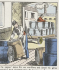
Ce papier sans fin est enroulé sur un grand rouleau aux imprimeries de journaux. Les presses à journaux sont alors réglées en ce qu'elles sont constituées au préalable par deux cylindres garnis des formes ou clichés entre lesquels le papier, passé enroulé, s'imprime à la fois recto et verso. A l'issue sort : une coupeeuse qui coupe le journal aux dimensions voulues, et une presse qui le plie.
