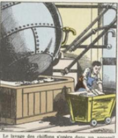
Le lavage des chiffons s'opère dans un appareil appelé pile lavante, constitué par une grosse sphère métallique mobile autour de deux tourillons creux par lesquels arrive de la vapeur qui barbotte dans l'eau où baignent les chiffons. On blanchit en même temps ceux-ci en ajoutant à l'eau de la soude ou de la chaux éteinte.
