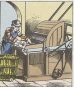
Afin de pouvoir travailler les chiffons, on les soumet à une COUPEUSE mécanique qui les débite en minces fragments. Cette machine peut ainsi couper chaque jour plusieurs milliers de kilogrammes de vieux chiffons.
