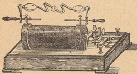
La bobine proprement dite est montée sur un socle en acajou renfermant le condensateur. Sur le devant du socle se trouvent deux bornes destinées à amener le courant de la pile. Sur les joues de la bobine se trouvent deux petites bornes après lesquelles on attache les fils conducteurs servant à faire les expériences.
