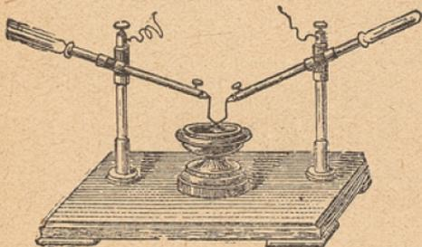
**Table à expériences.** — Cet appareil se compose d'un pied avec glace isolante placé sur la planchette entre deux colonnes, servant à amener le courant d'induction dans les deux tiges mobiles.
