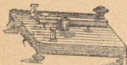
pouvoir changer le sens du courant. A cet effet, on se sert soit du commutateur rotatif de Ruhmkorff, soit de l'inverseur à lames. En tournant le bouton du premier ou en déplaçant les lamelles du second de ces appareils, le courant entre par la borne de droite ou par celle de gauche.
