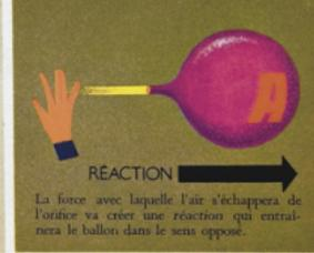
La force avec laquelle l'air s'échappera de l'orifice va créer une réaction qui entraînera le ballon dans le sens opposé.
