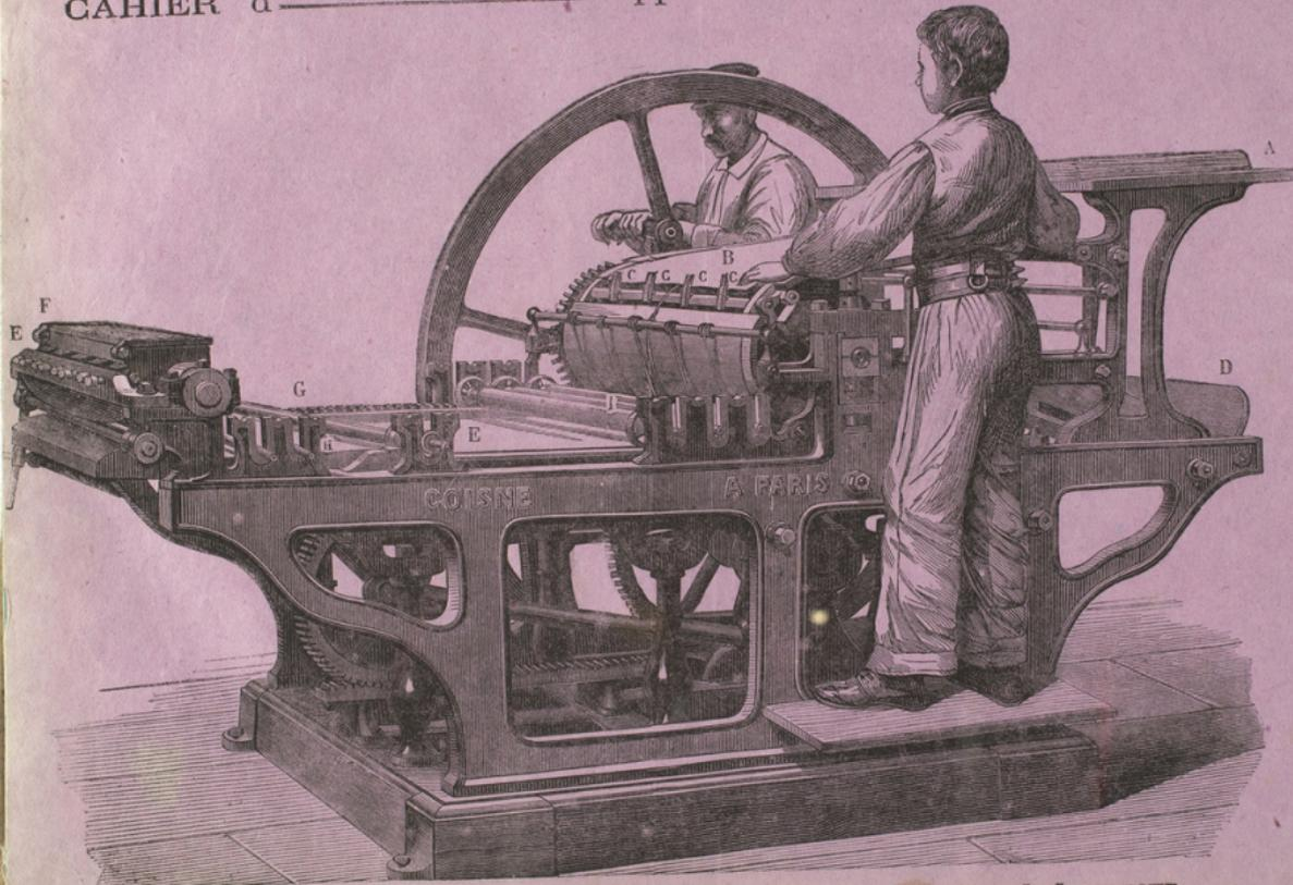
MACHINE MÉCANIQUE, fonctionnant, soit à bras, soit au moyen de la vapeur
