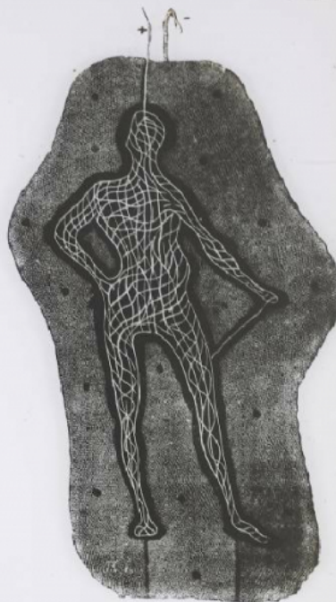
- Carcasse de platine pour la reproduction des statues et statuettes (procédé Lenoir)
