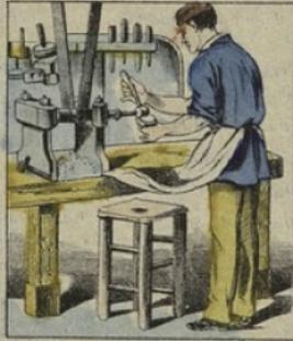
Avant de recouvrir d'argent les couvertes ainsi obtenus, il faut leur donner un polissage parfait qui met le métal au vif. On recouvre chaque pièce de fine pierre ponce imbibée d'huile et on l'applique vigoureusement contre une brossa circulaire à mouvement très rapide qui, en un clin d'œil, donne le poli le plus brillant.
