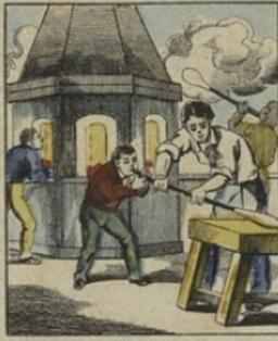
Le verre est un silicate, c'est-à-dire un composé de silice (sable, pierre à fusil) et de soude, de potasse et de chaux. On mélange ces divers produits dans des creusets chauffés au rouge dans des fours ou briques réfractaires: en se fondant, ils forment du verre.
