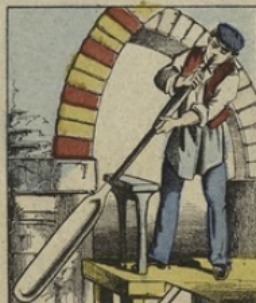
Pour fabriquer le VERRE À VITRES, l'ouvrier essaie comme toujours, dans le creuset, une lame de verre au bout de sa canne. Puis, il la souffle jusqu'à ce qu'elle ait acquis la forme d'un grand manchon fermé aux deux bouts.
