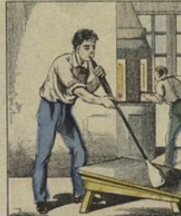
Quand le verre est fondu, un apprenti plonge dans le creuset le bout d'une canne creuse en fer et l'apporte à l'ouvrier verrier qui se met à souffler dans la canne, comme lorsque nous faisons des bulles de savon. Aussitôt la bulle de verre se gonfle et s'allonge à la volonté du souffleur.
