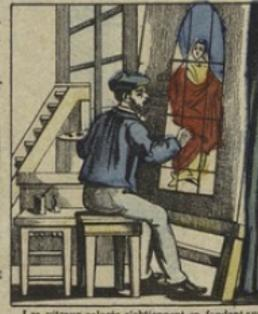
Les vitraux colorés s'obtiennent en fondant avec le verre un peu d'oxydes métalliques. Le verre bleu s'obtient avec du cuivre; le jaune avec de l'argent; le rose avec de l'or et de l'étain; le rouge avec du fer et du cuivre; le vert avec du nickel et de l'uran, etc. Les plus anciens vitraux sont ceux de Brioude, de Tours et de Saint-Denis.
