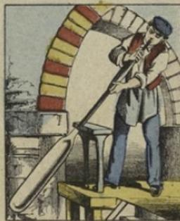
Pour fabriquer le VERRE À VITRES, l'ouvrier essaie comme toujours, dans le creuset, une lame de verre au bout de sa canne. Puis, il la souffle jusqu'à ce qu'elle ait acquis la forme d'un grand manchon fermé aux deux bouts.
