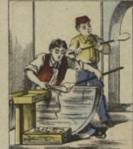
A l'état pâteux, le verre se laisse façonner de toutes les façons imaginables. Pour fabriquer un VERRE À BOIRE ou UNE CARAFE, on fait tourner vivement la canne de fer avec la bulle de verre soufflé au bout, et on lui fait prendre, avec des caillots, toutes les formes voulues.
