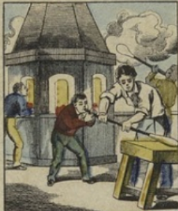
Le verre est un silicate, c'est-à-dire un composé de silice (sable, pierre à fusil) et de soude, de potasse et de chaux. On mélange ces divers produits dans des creusets chauffés au rouge dans des fours ou briques réfractaires: en se fondant, ils forment du verre.
