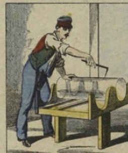
On ouvre avec une pointe de fer rouge les deux caillots qui ferment les bouts du manchon: puis un ouvrier ferme tout le long du manchon une ligne de fer pointu qui fend le cylindre de verre en deux aussi nettement que le ferait un diamant.
