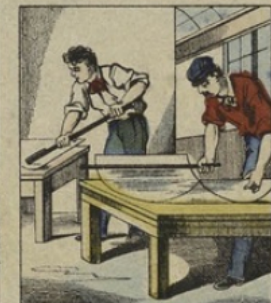
Le manchon une fois fendu, peut s'ouvrir et se développer sur une plaque d'argile qu'on remet au four pour le réchauffer. Avec une longue perche de bois, on rabat les deux côtés et on les aplatisse de façon à obtenir une surface aussi dressée que possible.
