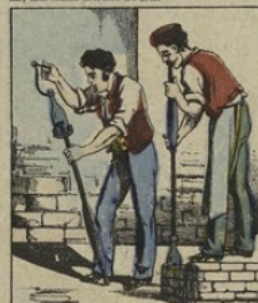
Pour fabriquer une BOUTEILLE, on se sert de verre moins pur et moins cher; la coloration verte est due à la présence d'un peu d'oxyde de fer. La plus ancienne fabrication, en France, est celle de Quimper (Aisne) et date de 1250.
