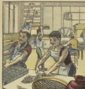
Dans les grandes usines où se fabrique le chocolat, les graines de cacao, après triage et épuration à la machine ou à la main, sont introduites dans des broyeurs en tôle où s'opère la torréfaction. Elles sont ensuite mises à refroidir sur des claies; puis à leur écouage qui se pratique dans deux cylindres concaveurs armés de broches: celles-ci, brisant les cosques, mettent les amandes à nu et les en séparent.
