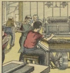
Après nouveau triage, les amandes sont broyées et réduites mécaniquement en une pâte semi-liquide par addition progressive de la quantité d'eau nécessaire. A cette pâte s'ajoute alors le sucre raffiné, opération qui se fait dans des mélangeurs, vases en fonte à fond de granit dans lesquelles tournent deux cônes tronqués en granit. Le mélange intime opéré, on soumet encore la pâte à un dernier broyage en ajoutant de la vanille ou autres aromates.
