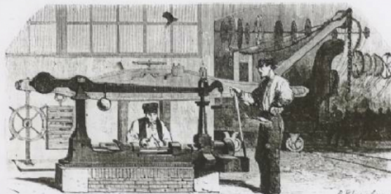
Machine à éprouver la résistance des tôles.
