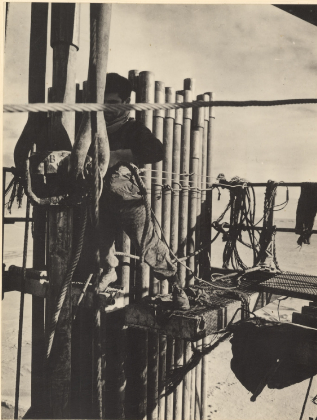
SAHARA HASSI-MESSAOUD: Travail sur derrick; forage: accrocheur en action (Photo CFP)
