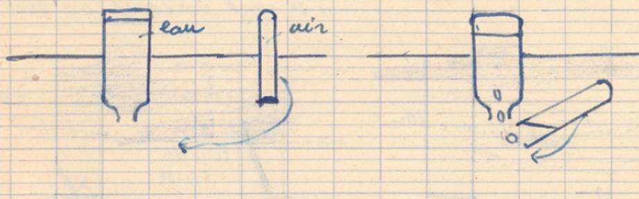
L'air du tube (qui semblait vide) pénètre dans le flacon
