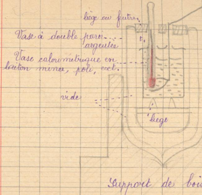
Dispositif d'un calorimètre moins coûteux
