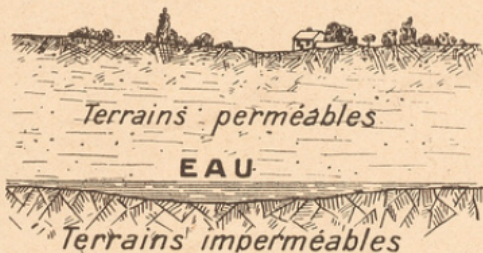
Coupe théorique de la formation d'une nappe souterraine
