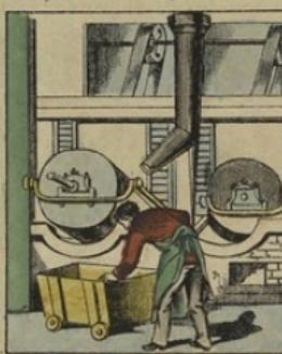
Le Café mélangé est versé dans des trémies d'où il tombe dans les appareils à torréfaction par des conduites en tôle qui mesurent mécaniquement la quantité nécessaire pour chaque brûloir mis à la vapeur et tournant régulièrement dans de grands fourneaux où les grains de Café sont uniformément torréfiés.
