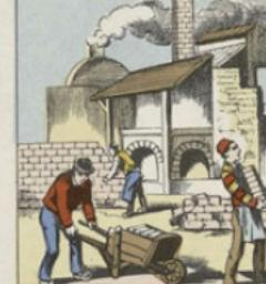
La pâte est placée dans des moules au sortir desquels la brique crue, ainsi obtenue, est mise à sécher au soleil, puis à cuire dans des fours ou elle séjournera de 30 à 35 jours. Une brique de bonne qualité doit avoir une couleur rouge brûlé foncé et rendre un son clair quand on la frappe.
