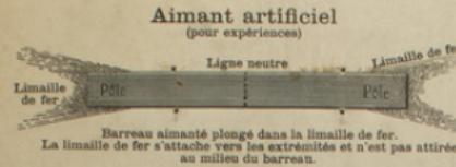
Barreau aimanté plongé dans la limaille de fer. La limaille de fer s'attache vers les extrémités et n'est pas attirée au milieu du barreau.
