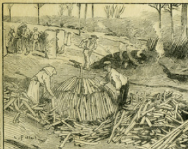
Fig. 7. — Les phases de la fabrication du charbon de bois: construction d'un four; un four en combustion; mise en sacs.
