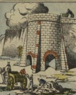
Les pierres calcaires sont généralement un composant d'ardoise, de mortier et de chaux (ou carbonate de chaux). Pour faire de la chaux et du carbonate, il faut chasser l'acide carbonique, ce qui s'obtient en calcinant la pierre dans des FOURLA CHAUX au rouge pendant plusieurs heures.
