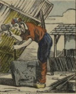
L'ardoise est un SCHISTE naturel qui joint de la propriété de se diviser par le choc en lames minces. L'ardoise noire est la meilleure. La bonne ardoise doit être pesante, dure, et ne pas BOIRE quand on la trempe dans l'eau. Les principales ardoises se trouvent près d'Angers.
