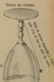
La balle de caoutchouc est chassée par le bord du verre qui vibre.
