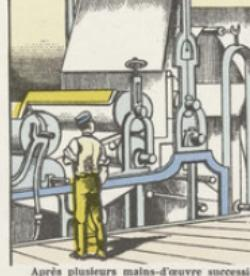
Après plusieurs mains-d'œuvre successives, la pâte est transformée par une machine spéciale en papier sans fin qui s'enroule sous forme de bobine, sans jamais s'arrêter ni jour ni nuit.
