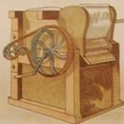
Despepitadora ó desmotadora de algodón
