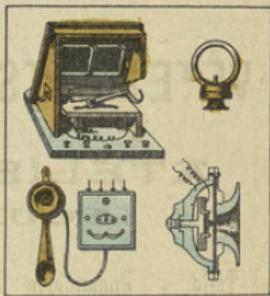
On construit, en effet, une variété infinie de récepteurs et de transmetteurs plus ou moins simplifiés. Nous citerons seulement les transmetteurs Ader, Baillieux, Bert d'Arsonval, Berthon, Deckert, Solid Back et les récepteurs Ader, Aubry et Bert d'Arsonval.
